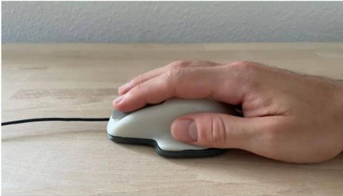
Ergonomietest mithilfe einer 3D-gedruckten Version.
