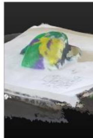
Mit Smartphone gescannter Formprototyp aus Knetmasse.
